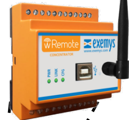
Concentrator (ZigBee + 3G)
